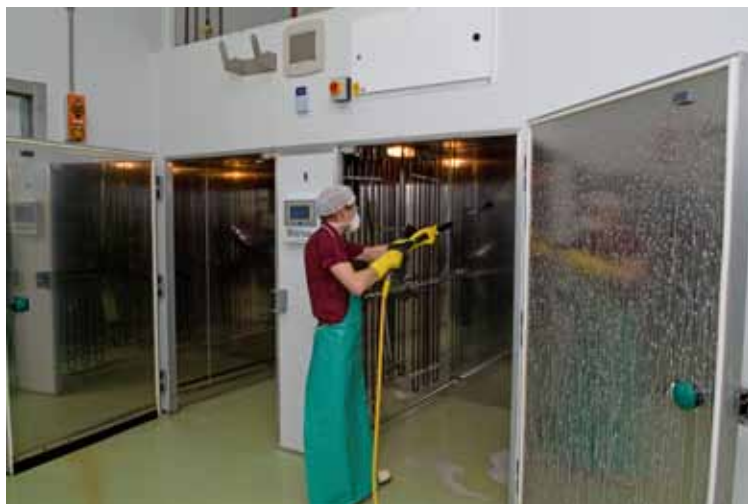
Схема 12: Применение системы низкого давления для мытья выводного шкафа.
