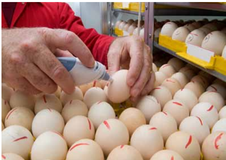
Схема 9: Проверка температуры неоплодотворенных яиц для определения точек переохлаждения и перегрева в инкубационном шкафу.
