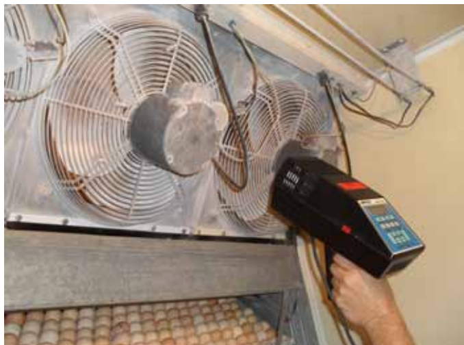
Схема 6: Применение стробирующего светового сигнала для проверки скорости работы вентиляторов.
