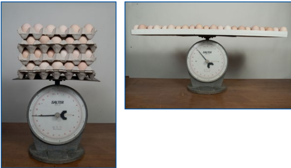
Figura 54: Pesaje colectivo de una muestra de huevos.
