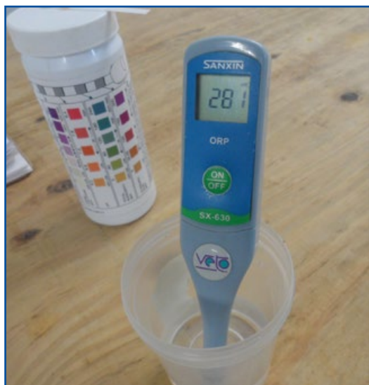
Figura 126: Ejemplo de un medidor de ORP.
